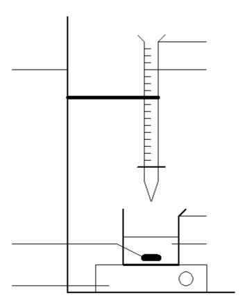
✓ Verser <u>peu à peu</u> la solution de soude dans le bécher et passer <u>au goutte à goutte</u> lorsque la teinte de la solution devient verte. Arrêter le titrage lorsque la solution est devenue bleu et noter le volume V<sub>BE</sub> de soude versé
