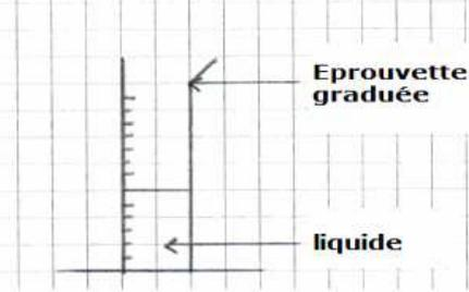
Introduire le liquide dans l'éprouvette graduée et mesurer précisément son volume.
