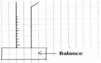
Poser l'éprouvette graduée sur la balance et effectuer la tare pour enlever sa masse.
