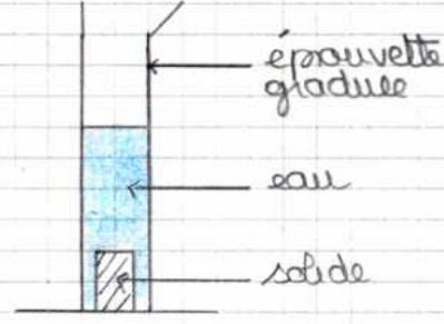
**2ème étape :** introduire le solide dans l'éprouvette graduée et mesurer le volume de l'eau AVEC le solide, que l'on notera V2
