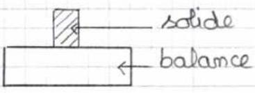
Allumer la balance puis poser le solide sur le plateau afin de mesurer sa masse, que l'on notera m
