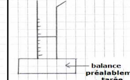
Reposer l'éprouvette graduée sur la balance pour mesurer la masse du liquide.
