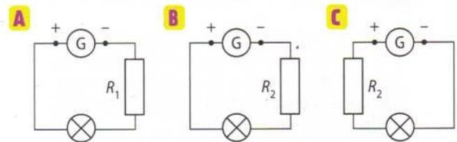
Elle a noté ses observations : « La lampe brille normalement dans le circuit **A**. Elle brille faiblement mais de façon identique dans les circuits **B** et **C**. »
